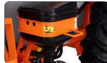
Incorpora o defensivo à água do tanque de 2000 litros, produzindo a calda de forma prática e segura, reduzindo o risco ao meio ambiente e ao operador.
