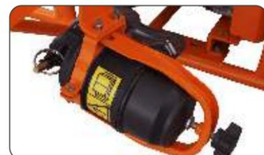
O sistema de filtragem do circuito hidráulico de pulverização é composto por um filtro de sucção, FVS 100, com malha de aço inox e fecho rápido; filtros de linha (opcional), um para cada segmento das barras de pulverização; filtros em todos os bicos, proporcionando uma excelente qualidade de aplicação.
